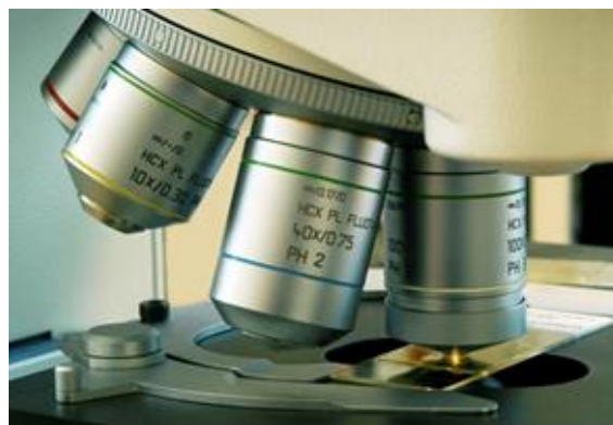
Figur 31. Provtagning av kiselalger görs i första hand genom borstning av stenar varefter kiselalgspreparat framställs och analyseras i mikroskop i 1000 gångers förstoring (objektiv100x), © Medins Havs och Vattenkonsulter AB.
