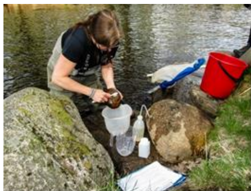
Figur 31. Provtagning av kiselalger görs i första hand genom borstning av stenar varefter kiselalgspreparat framställs och analyseras i mikroskop i 1000 gångers förstoring (objektiv100x), © Medins Havs och Vattenkonsulter AB.
