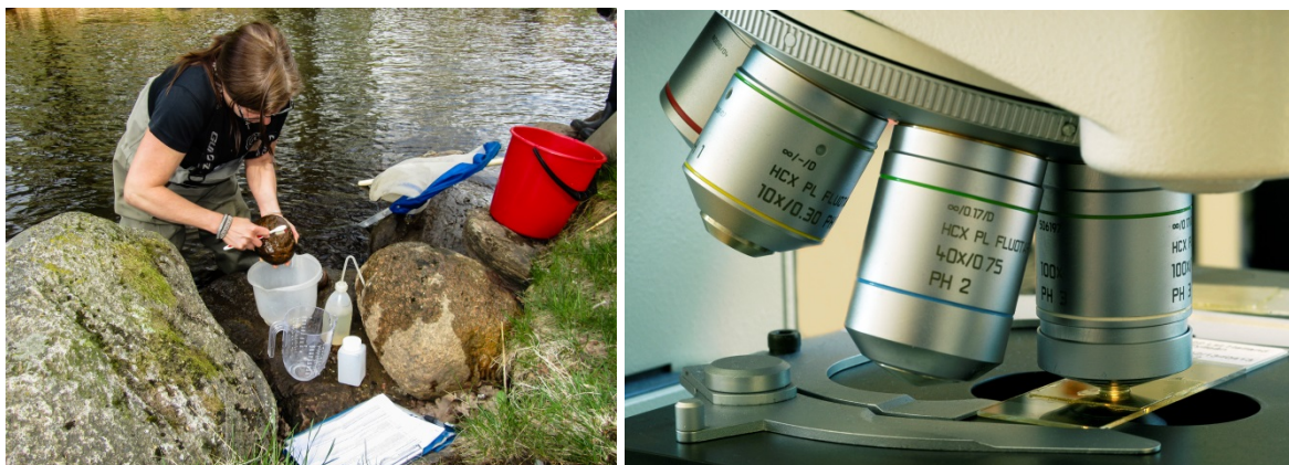
Figur 1. Provtagning av kiselalger görs i första hand genom borstning av stenar varefter kiselalgspreparat framställs och analyseras i mikroskop i 1000 gångers förstoring (objektiv 100x). © Medins Havs- och Vattenkonsulter AB.
