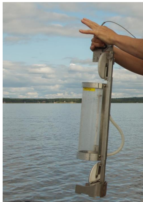
Figur 29. Ruttnerhämtare av limnostyp © SGS.
