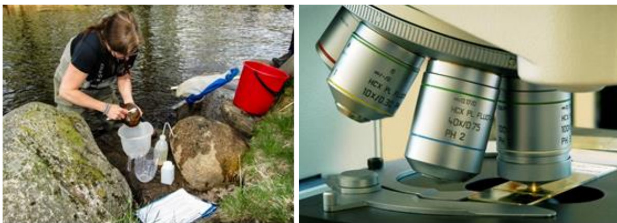
Figur 30. Provtagning av kiselalger görs i första hand genom borstning av stenar varefter kiselalgsspreparat framställs och analyseras i ljusmikroskop med 1000 gångers förstoring (objektiv 100x), © Sweco Sverige AB.
